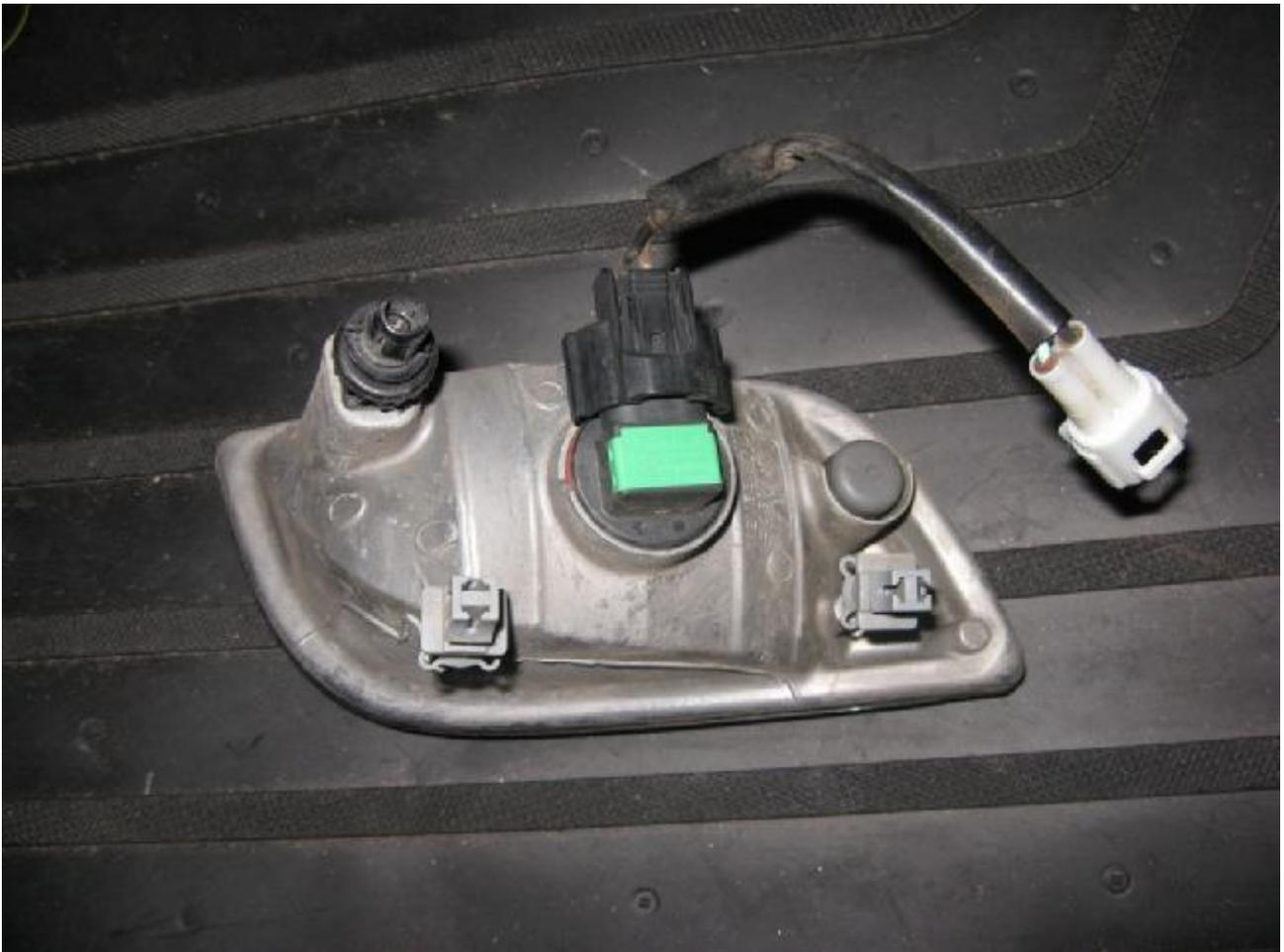
На схеме ниже есть каталожные номера для заказа. Клипсы, лампочки (используются лампочки с цоколем Н11) и переходники не поставляются в комплекте с оригинальными и большинством неоригинальных ПТФ.
