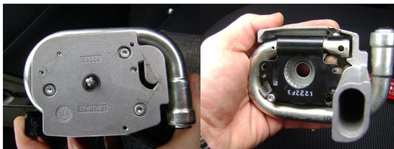
Снимаем чёрную пластину с трубкой - «пушкой» (один винт с головкой Т10) и удаляем звёздочку с зубцами, вытряхиваем ВСЕ шарики (их там около десятка) и срезанные при выстреле маленькие штифты, на которых стояла звёздочка. Всё это теперь лишнее.
