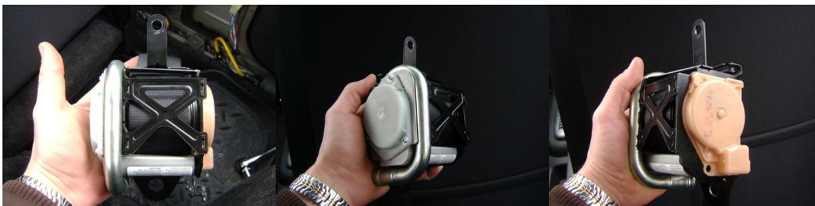
Отворачиваем 3 винта крепления пружинного блока, прижимая белую крышку к корпусу пальцами. После того как винты вывернуты необходимо продолжая прижимать блок к корпусу вращать его до полного ослабления пружины. Если это проделать аккуратно, то разбирать блок не потребуется. Проверить это можно надев блок обратно на ось катушки и поворачивая в обратном направлении. Если пружина взводится – всё в порядке, откладываем блок в сторону.
