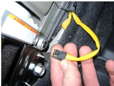
Головкой (ключом) на 14 отворачиваем болты верхнего и нижнего креплений ремня, механизма ремня.
