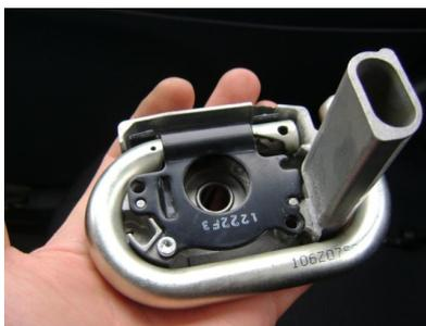
Не устанавливая механизм преднатяжителя на место, выдавливаем штифты трёх «клопов» крепления противоположной крышки.
