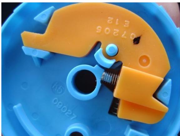
Собираем механизм как показано на фото ниже. Пружину можно заправить отвёрткой, или надевать колесо, уперев пружину в край паза.
