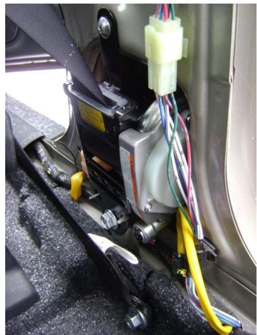
Отсоединяем провод (он не понадобится до установки нового ремня)
